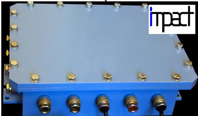
Импакт Сэнд - это стационарный диагностический контроллер, обеспечивающий обнаружение наличия песка, переносимого потоком газа по трубе, а также технологии, позволяющие определять его количество, основываясь на вибрационных и акустических методах. Эти технологии являются комбинацией физики, математики и практического опыта работы на большом количестве нефтегазовых объектов.
