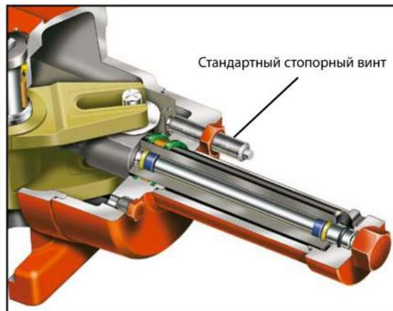
Конфигурация гидравлической блокировки
