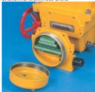
Съемный клеммный блок для подачи напряжения питания
