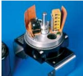
Распределительные коробки HDN могут поставляться в водонепроницаемом исполнении (IP 67 в соответствии со стандартом IEC 529) и взрывобезопасном исполнении, таком как EEx d или EEx i (сертификация ATEX) или по классу I, Разделу 1, Группам C, D, Классу II, Разделу 1, Группам E, F, G. (сертификация CSA).
