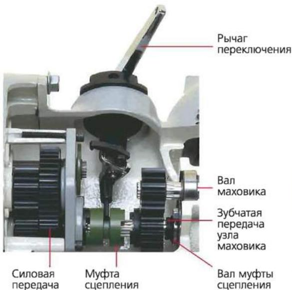
Простой и надежный механизм переключения на ручной режим. Переключение не требует усилий.
