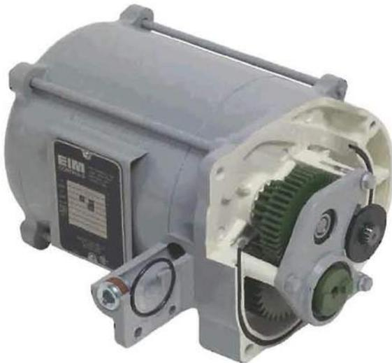
Двигатель с цилиндрической силовой передачей образует единый модуль, который крепится к приводу восьмью болтами.
