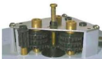
Механический счетчик количества оборотов
