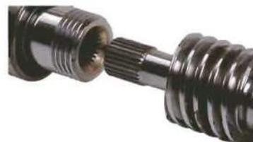
Шлицевое соединение с валом муфты сцепления
