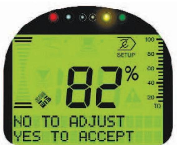
Дисплей отображает привод в режиме настройки, клапан открыт на 82%.
