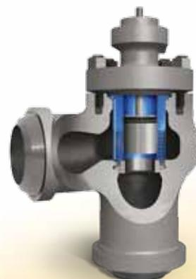
**Кавитирующая жидкость** - Трим Cavitrol™ III содержит множество отверстий специальной формы, позволяющих уменьшить турбулентность потока. Кроме того, отверстия радиально ориентированы по отношению к потоку, протекающему от одного сужения к другому. Обе эти особенности конструкции обеспечивают плавное снижение давления среды и предотвращают кавитацию.
