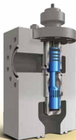
**Дегазация** - Dirty Service Trim for Outgassing (DST-G) используется в системах, где рабочая жидкость содержит растворенные газы, которые выделяются при снижении давления. При этом конструкция трима позволяет проходить частицам размером 6,35 мм (¼ дюйма).
