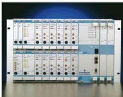
Система контроля рабочего состояния оборудования CSI 6500
