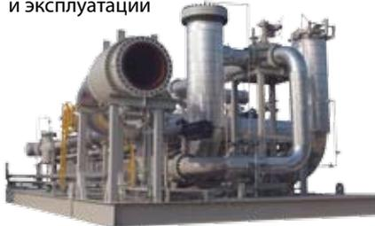
таких систем с более чем столетней историей. Это полностью собранные и протестированные на заводе узлы учета, включающие в себя все необходимые компоненты, такие как: входные и выходные коллектора, измерительные трубопроводы с запорно-регулирующей арматурой, расходомеры любого принципа действия, датчики давления, перепада давления, температуры или многопараметрические, вычислители расхода, блоки качества и супервизорная система, например, DanPac.
