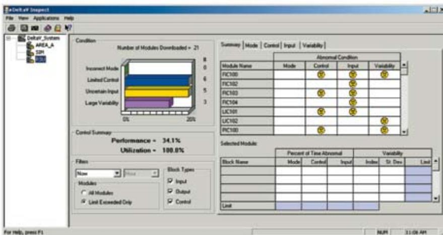
*Интуитивно понятный интерфейс Инспектора DeltaV позволяет Вам быстро определить проблемные точки контуров и оборудования*
