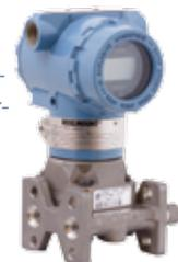
Датчик Rosemount 3051C/T предназначен для измерения разности давлений, избыточного давления, абсолютного давления, уровня жидкости и может применяться для высокотемпературных технологических процессов. Усовершенствование платы электроники, модуля сенсора и клеммного блока привели к значительному увеличению срока службы датчиков.
