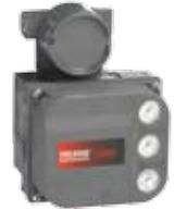
Контроллер принимает сигнал обратной связи, пропорциональный величине хода клапана. Это позволяет контроллеру проводить не только самодиагностику, но также и диагностику клапана с приводом. Контроллеры используют двухпроводный аналоговый (4-20 мА) контур, что позволяет провести замену существующих приборов с минимальными затратами. Для двухпроводных контуров одна и та же линия является сигнальной линией и линией питания, что сокращает расходы на установку и обслуживание.
