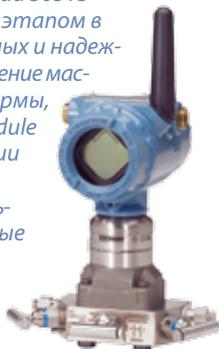
Датчики Rosemount 3051S предназначены для измерения разности давлений, абсолютного давления, избыточного давления, уровня жидкости с самой полной линейкой возможных соединений с технологическим процессом (Cорplanar™, резьбовое и фланцевое соединения) и материалами разделительной мембраны (нержавеющая сталь 316L; сплавы Hastelloy® и Monel®, в том числе и с золотым покрытием; тантал).
