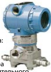
Расходомер интегральной конструкции с многопараметрическим преобразователем Rosemount 3095 заменяет работу нескольких устройств и компонентов традиционного расходомерного узла, необходимых для измерений параметров среды и вычислений массового расхода.
