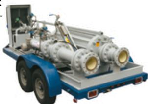
счетчиков. Небольшой размер, вес и высокий коэффициент изменения диапазона измерения 1000:1 делают возможным установку прuverа на платформе грузовика или прицепа. Это позволяет применять один прuver в нескольких точках для линий разного размера.
