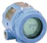
Микропроцессорная электроника преобразователей позволяет принимать входные сигналы от термометров сопротивления и термопар различного типа, а также сигналы от омических и милливольтовых устройств. Rosemount 3144P могут одновременно принимать входные сигналы от двух первичных преобразователей любого типа.
