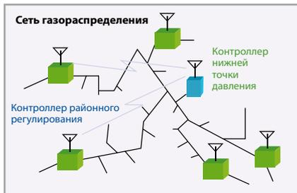
Система регулирования давления газа GridBoss в типичной газораспределительной сети
