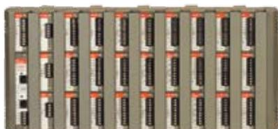
Контроллер серии ROC800 сочетает в себе функциональность трех отдельных приборов: контроллера телемеханики, компьютера расхода и программируемого логического контроллера.
